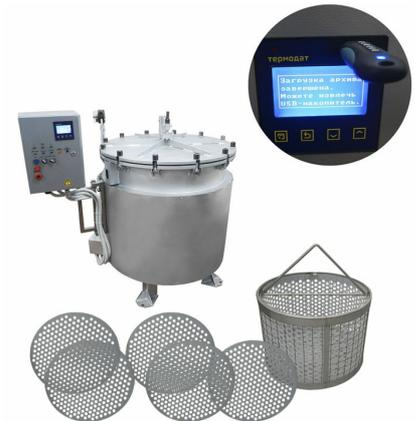
Автоклав выполнен из конструкционной стали с термостойким покрытием, также в состав входит одна загрузочная корзина из пищевой нержавеющей стали, пять перфорированных пластиковых полок для банок и вкладыш по периметру для исключения контакта жестяных банок с материалом нержавеющей корзины.
