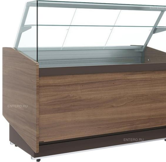
Кондитерская витрина \*\*Carboma KC80 N 1,5-1 BORNEO\*\* используется на предприятиях общественного питания и торговли для демонстрации и кратковременного хранения продукции, не требующей определенного температурного режима. Модель оснащена неохлаждаемой стеклянной полкой и регулируемыми ножками высотой от 30 до 50 мм. Зона выкладки и столешница выполнены из шлифованной нержавеющей стали.
