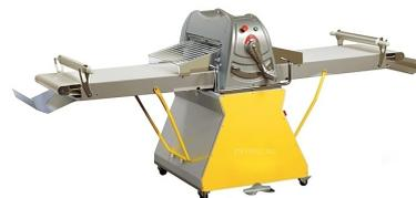
Напольная машина **PANERO SF600-1200** используется для раскатки различных типов и видов теста на ровные пласти. Модель предназначена для использования на предприятиях общественного питания с высокой проходимостью, а также в производственных цехах, деятельность которых связана с выпуском гастрономических товаров. Управление тестораскаткой осуществляется посредством педали и П-образного рычага.
