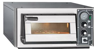
Облицовка выполнена из нержавеющей стали AISI 304, боковые и задняя стенки - покрыты порошковой краской, внутренняя поверхность - из эмалированного металла, жарочный шкаф - из оцинкованного листа толщиной 1,5 мм, ТЭНы - из нержавеющей стали.
