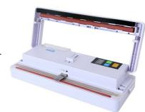
Длина запаечной планки в данной модели составляет 300 мм, ширина запаечного шва 4 мм. Мощность 150 Вт. Вакуумный упаковщик адаптирован для работы с различными термосвариваемыми материалами. Важно помнить что для сохранения эффекта вакуумизации необходимо использовать пакеты с барьерными свойствами.
