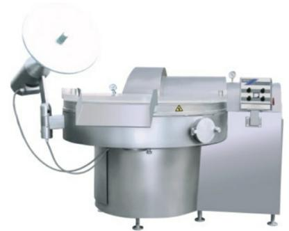
Привод ножевого вала оснащен преобразователем частоты для плавного переключения скоростей, количество ступеней – 4.
