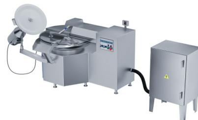
Куттер предназначен для промышленной переработки мясного и другого пищевого сырья. Основное предназначение – приготовление фарша из любых видов сырья. Куттер обеспечивает тонкое измельчение мяса и быстрое смешивание с другими компонентами. Полученный фарш используется для приготовления всех видов сосисок, сарделек и колбас. Оборудование также можно использовать для измельчения орехов, пюрирования овощей, фруктов и ягод.
