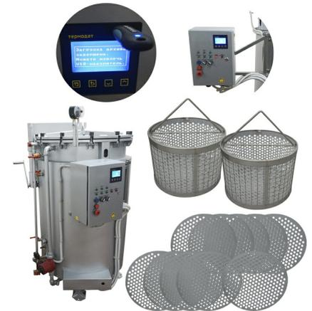
давления. По желанию Заказчика может дополнительно комплектоваться механизмом загрузки-выгрузки корзин ИПКС-128-500МВ, а также дополнительными загрузочными корзинами ИПКС-128-500К(Н).
