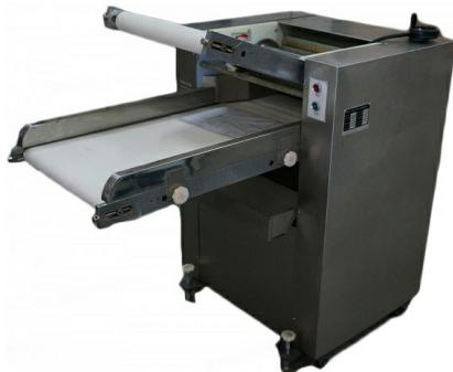
Автоматическая раскатка слоенного теста: машина автоматически складывает тесто за счет разной скорости движения верхнего и нижнего транспортеров
