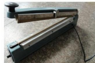
Модель импульсного запайщика KS - 400C часто используется при необходимости отрезки излишков пленки после запайки или при работе на рукавной пленке. Толщина шва составляет 2 мм. Длина запаечного шва 400 мм. Модель комплектуется боковым отрезным ножом для удаления излишков пленки.
