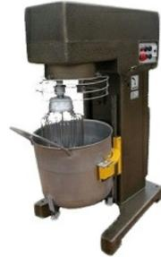
**Миксер МПВ-100** работает в полуавтоматическом режиме. Нажатием кнопок на пульте управления осуществляется подъем дежи, включается необходимая скорость вращения рабочего органа. Время работы устанавливается с помощью таймера. По завершении технологического времени вращение прекращается и дежа автоматически опускается. Работа с машиной практически не требует физических усилий.
